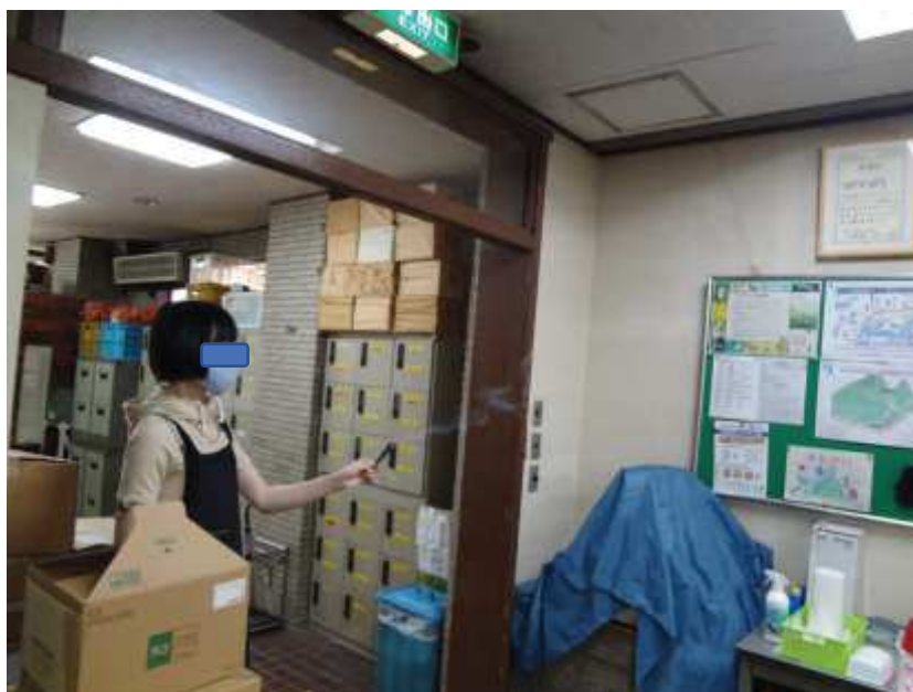
写真2 研修室入口から流れ込む気流
